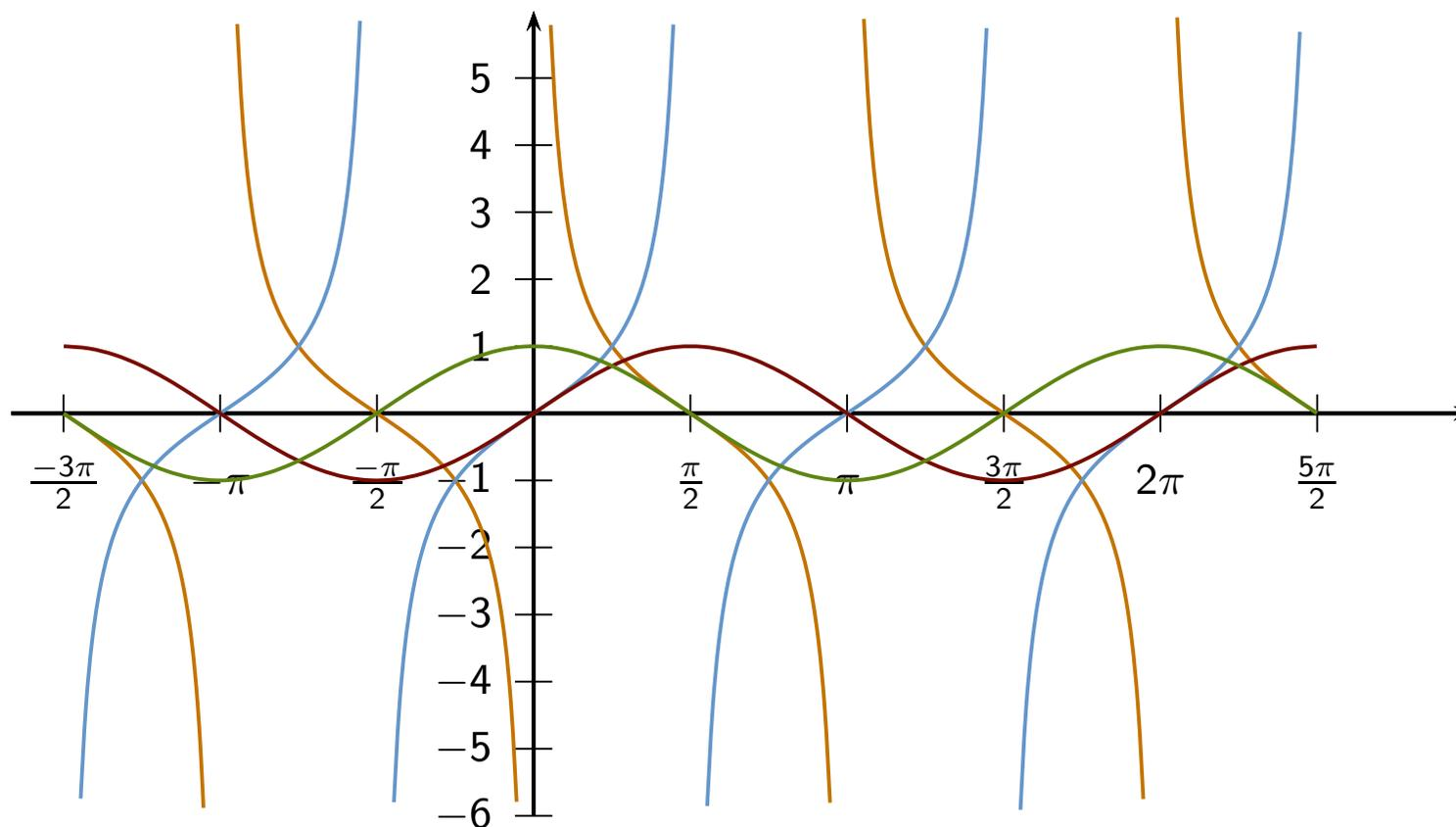
Abbildung: Graphen der trigonometrischen Funktionen Sinus (●), Kosinus (●), Tangens (●) und Kotangens (●)
